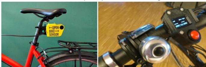
Bild: Abstandsmessung mit OBS – Sensor an Sattelstange und Anzeige mit Auslösesensor zur Aufzeichnung; Herr Görgen hat uns die Messergebnisse für Roßdorf präsentiert. Diese können über folgenden Link von jedem eingesehen werden: <https://obs.adfc-darmstadt.de/> Fotos: links AGFK-BW e.V., rechts C. Nintzel | REG.eV
